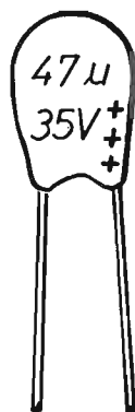
Fig. 6 - I condensatori al tantalio sono costruiti a forma di goccia. Sul loro involucro sono impresse le caratteristiche elettriche del componente: il valore capacitivo, la tensione di lavoro e la posizione dell'elettrodo positivo.
